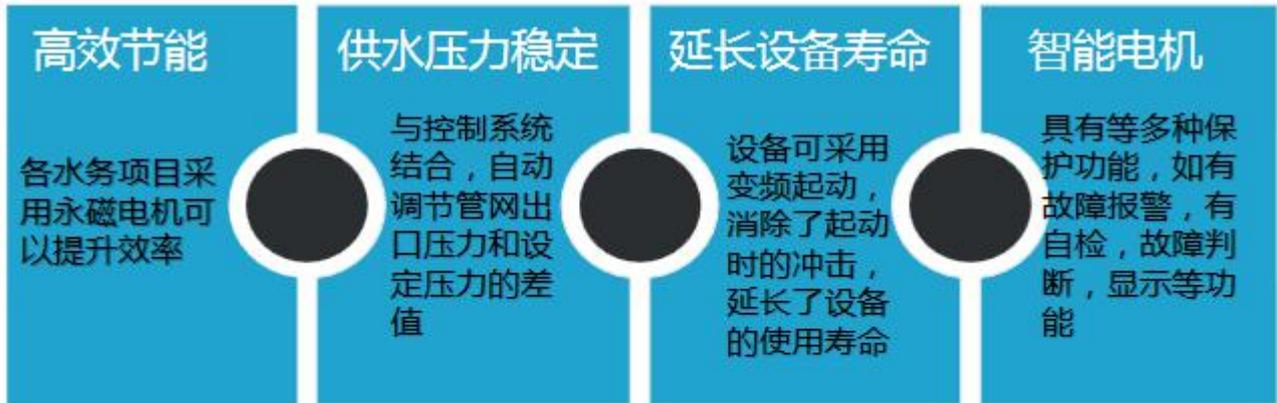
永磁电机与水泵配套使用，若工况为速度在60-100%额定转速下运行，则永磁电机及系统节能可达10%以上。永磁电机在低负荷工况下依然能保持较高的效率，与异步电机相比优势更加明显。
