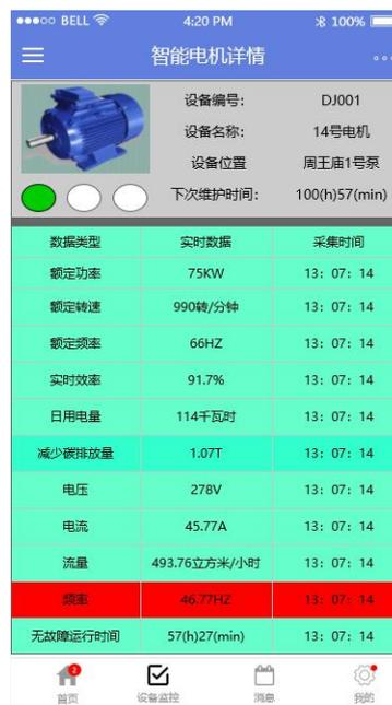
2、APP 远程故障分析。用户在 APP 上可在线检测电机各运行指标，通过与云端数据对比分析预测有可能出现的故障的概率，及时做出健康诊断。也可对已发生故障的设备进行在线故障诊断，判断故障发生原因，提高携带维修配件准确率，加快维修速度。
